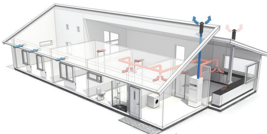
Obr. 3 Tepelné čerpadlo typu vzduch-vzduch 2
